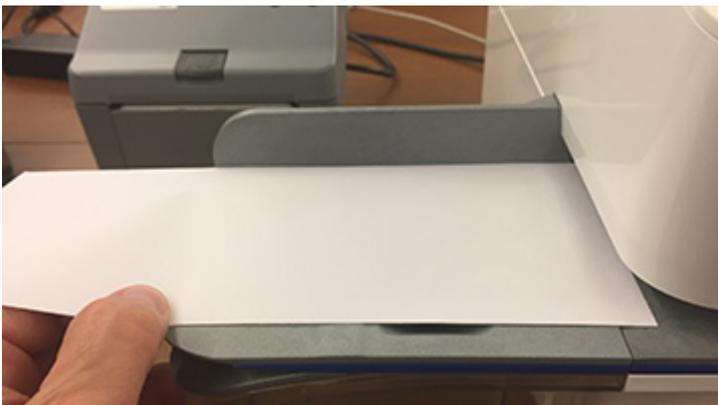
3. Wenn der Befeuchtertank voll ist und die Umschläge immer noch nicht ordnungsgemäß verschlossen werden, reinigen Sie Ihre Anfeuchtbürste und den Filz.
