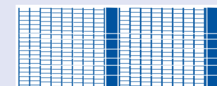
Schlechter Testdruck - fehlende Linien
