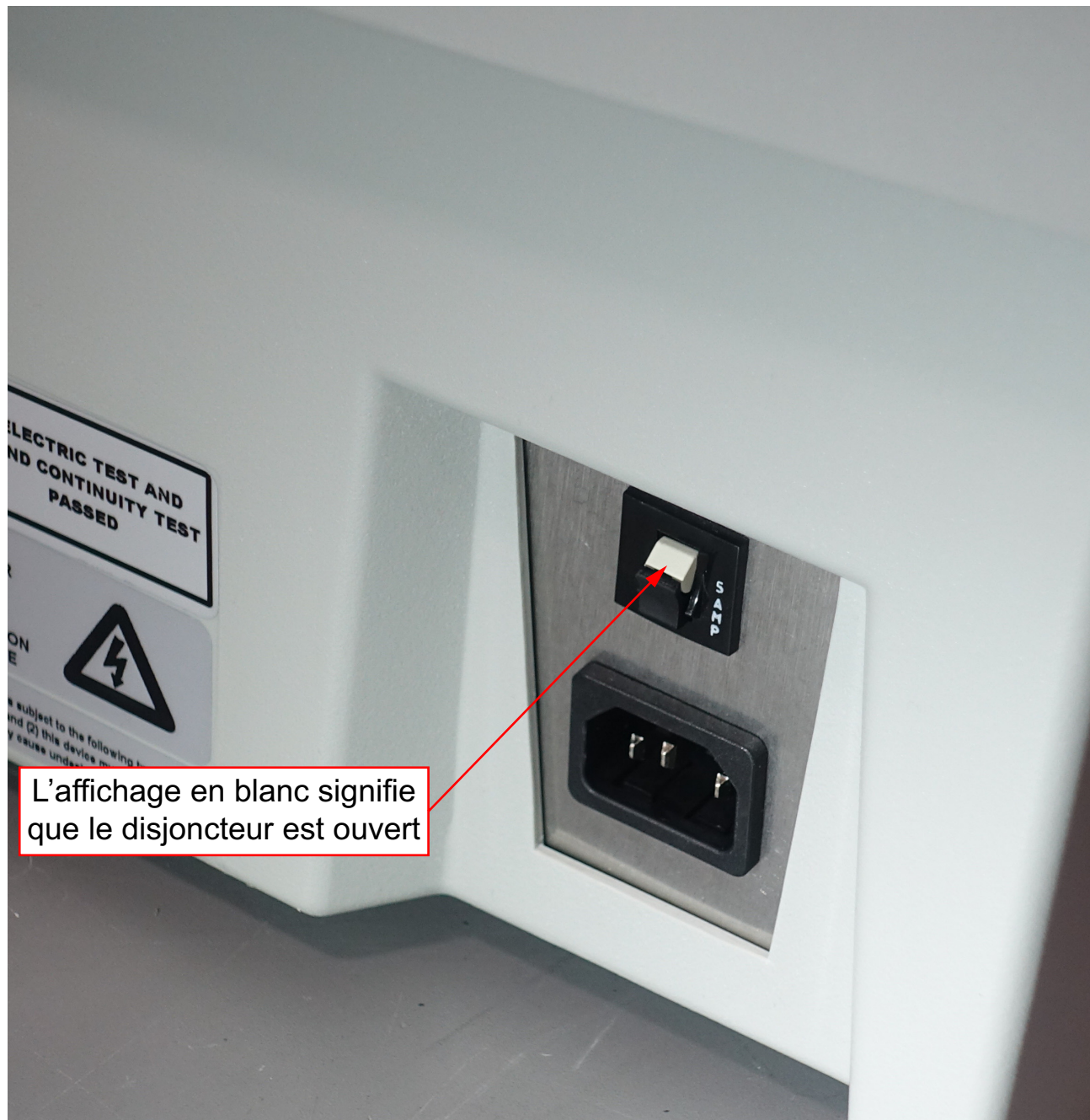
Figure 4-19 : Ouverture du disjoncteur
