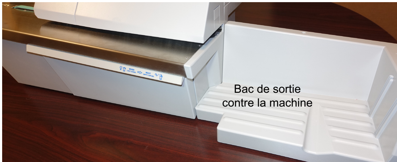
Figure 4-10 : Bac de sortie contre la machine
