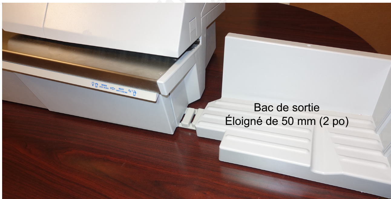
Figure 4-12 : Bac de sortie éloigné de 50,8 mm (2 po)
