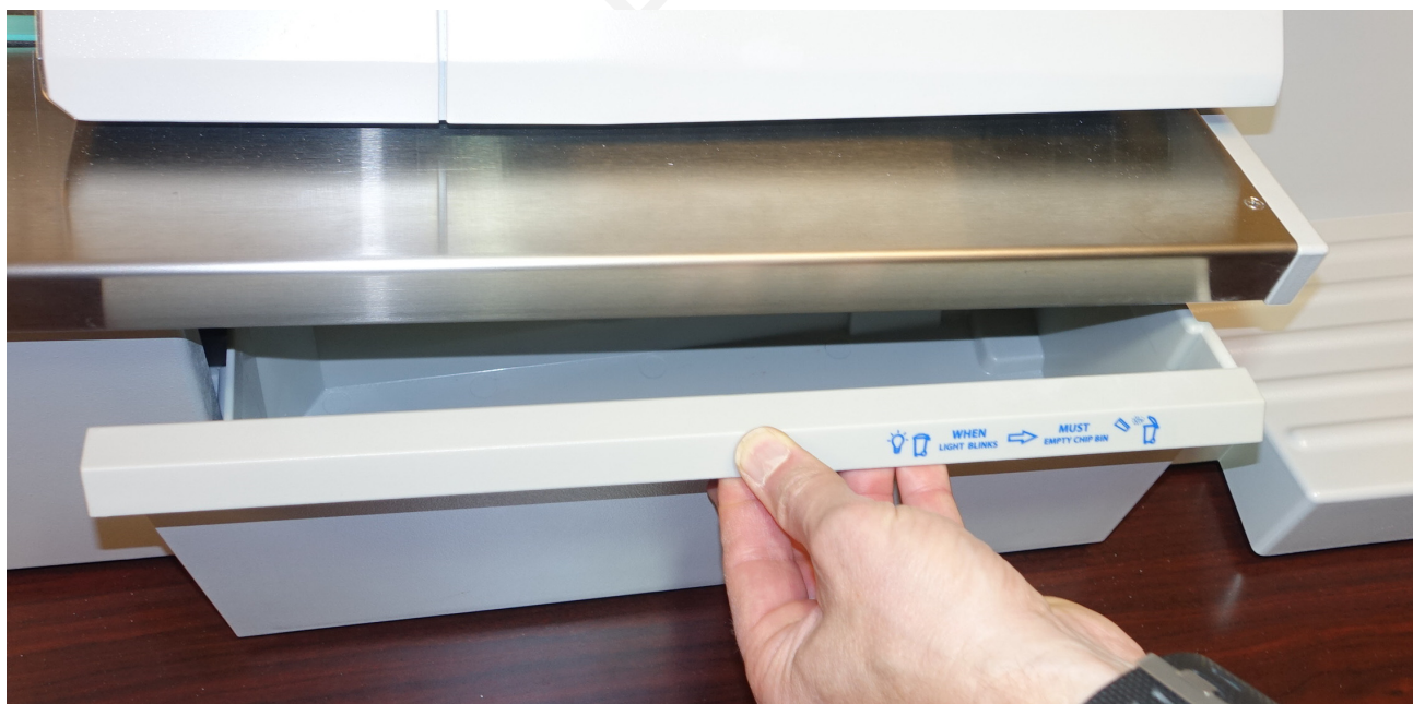
Figure 2-8 : Déclenchement de l'interverrouillage en cas de retrait du bac à copeaux
