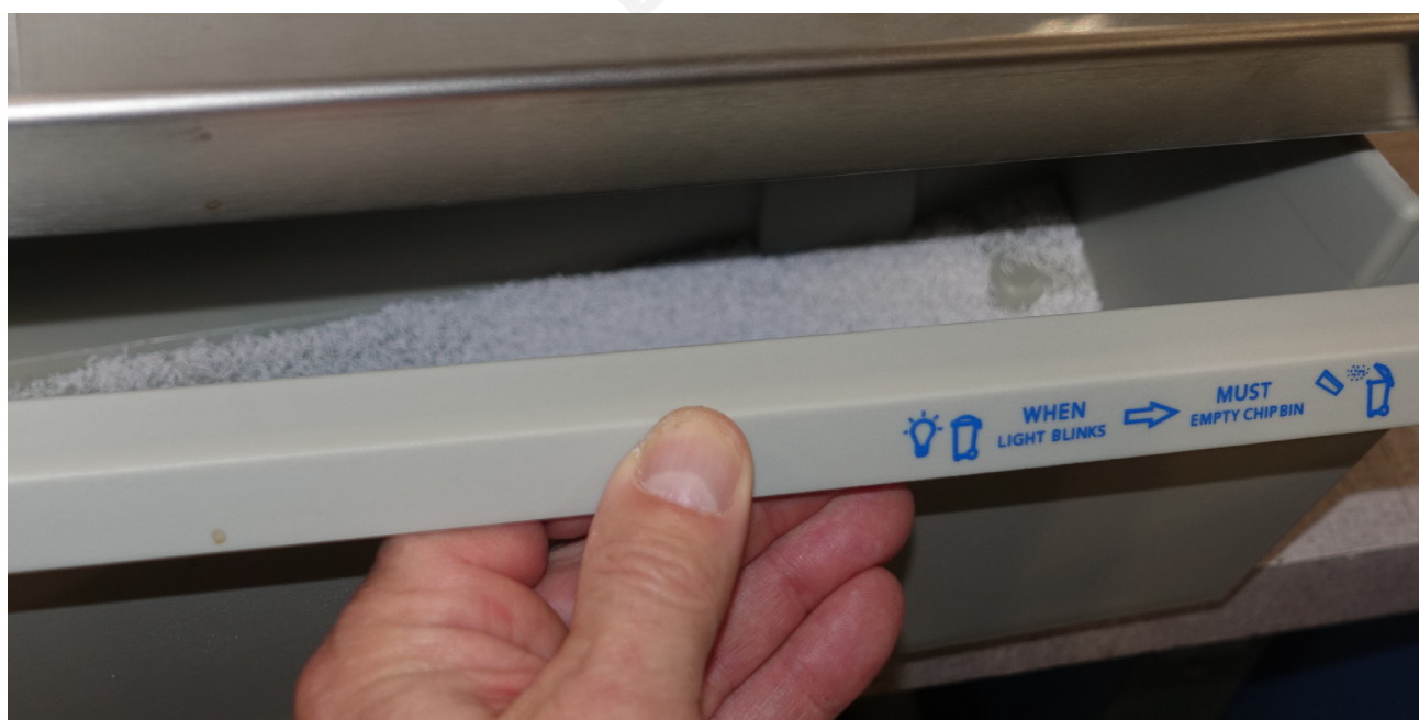
Figure 4-3 : Ouverture du bac à copeaux
