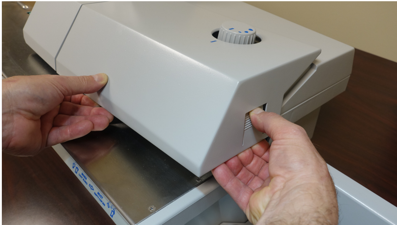
Figure 2-7 : Déclenchement de l'interverrouillage en cas de retrait du couvercle supérieur
