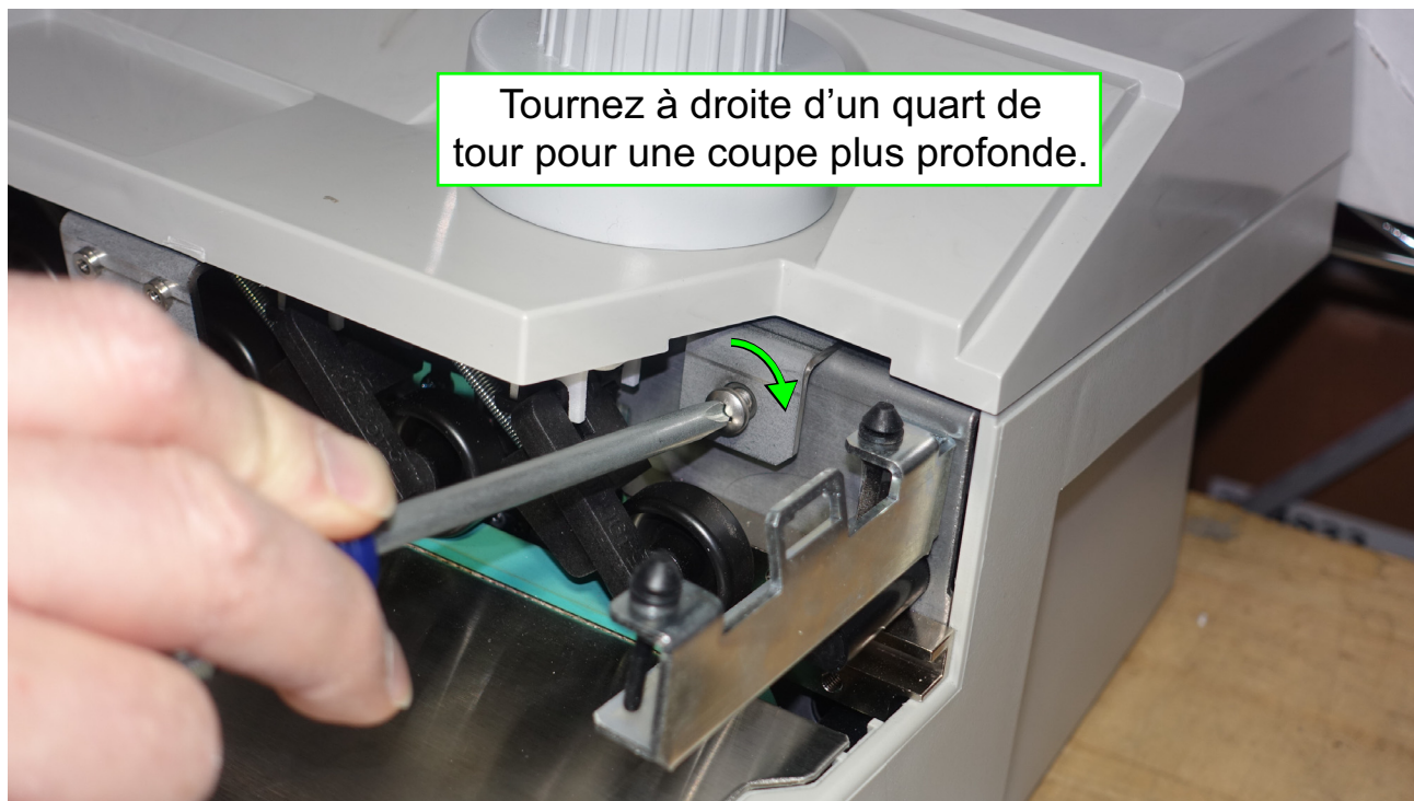
Figure 4-18 : Réglage de la profondeur de la fraise
