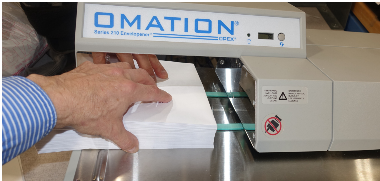
Figure 4-6 : Chargement de la trémie de chargement d'enveloppes
