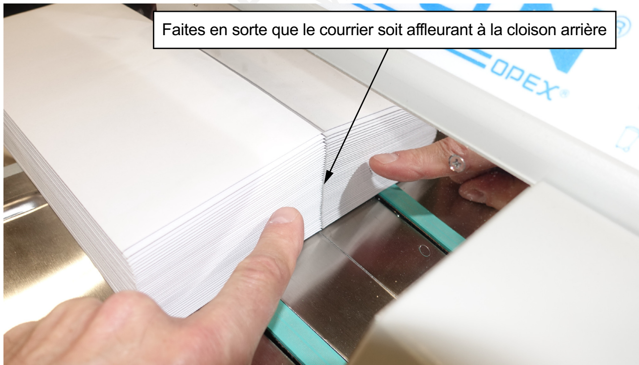
Figure 4-7 : Courrier affleurant à la paroi de la trémie de chargement
