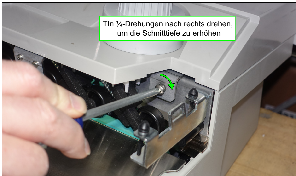
Abbildung 4-20: Einstellung der Schnitttiefe
