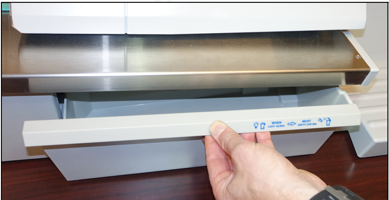
Abbildung 2-10: Die Verriegelung löst aus wenn das Schnipselband entfernt wird
